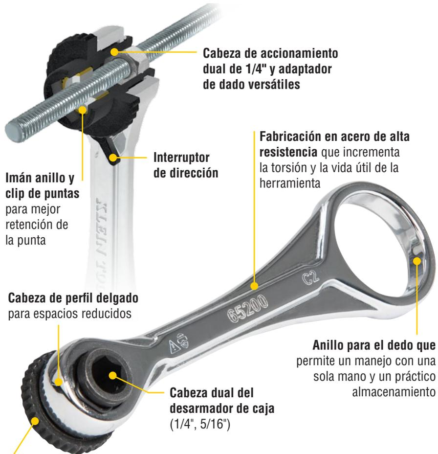
**Cabeza de accionamiento dual de 1/4" y adaptador de dado versátiles**
