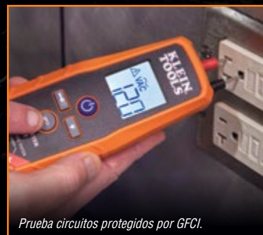
La linterna y la pantalla retroiluminada se encienden cuando se trabaja en entornos con iluminación escasa o nula. La pantalla LCD proporciona una medición de voltaje más precisa.
