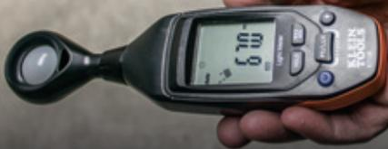
Der **ET130** ist ein bedienerfreundliches Präzisionsluxmeter für die einhändige Bedienung, das die Beleuchtungsstärke in Foot Candle (FC) und Lux misst.
