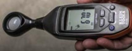
El **ET130** es un medidor de luz preciso, fácil de utilizar, operable con una sola mano, y que permite supervisar niveles de iluminación en pie-candela (fc) y lux.
