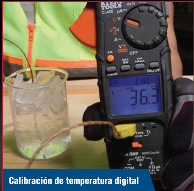
**Calibración de temperatura digital**
