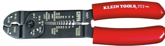
Esta multiherramienta realiza 6 funciones diferentes con la misma herramienta. Mide, corta y pela cables, mide y corta tornillos de máquina y poncha terminales y conectores con aislamiento. Utilice los agujeros roscados para medir con facilidad el tamaño de un tornillo de máquina y cortarlo si se requiere. Los mangos recubiertos en plástico son acojinados para mayor comodidad.
