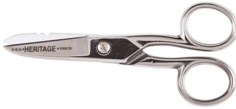
Las tijeras de Klein Tools de electricista están niqueladas y poseen agujeros pelacables para cables de calibre 19 y 23. Cuchillas reforzadas a 59-61C (dureza Rockwell) para brindar una vida útil de corte prolongada, y con bordes dentados para sujetar el cable al realizar los cortes. Fabricado con orgullo en los EE. UU.
