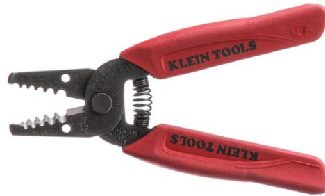
El pelacables/cortacables corta, pela, enlaza y mide cable trenzado de 8 a 16 AWG. Las medidas en sistema métrico son 6,0 mm<sup>2</sup> a 1,0 mm<sup>2</sup>. El mango de doble capa proporciona mayor estructura y comodidad, y se adapta mejor a la palma de la mano. Marcas de calibre de cable fáciles de leer en ambos lados para pelar el cable en cualquier dirección.
