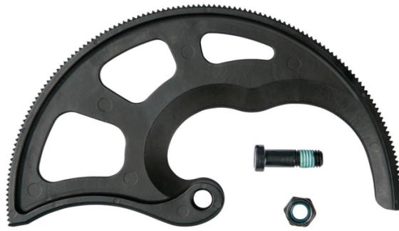
Juego de cuchillas de repuesto para el cortador multicable 63675 (edición 2017) de Klein. Las cuchillas de acero templado cortan cables de cobre de 1000 MCM y de aluminio de 1000 MCM. El juego incluye: cuchilla móvil de corte, tornillo fulcro, tuerca de sujeción para tornillo fulcro.
