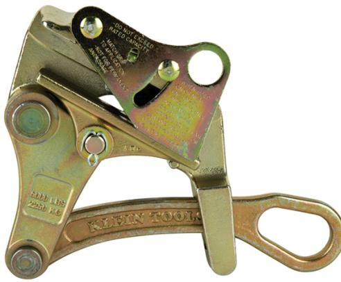
Este tensor liviano y compacto jala cables ACSR de 0,16" a 0,90" (0,4 a 2,3 cm) de diámetro. La mordaza redonda proporciona el máximo contacto con el cable a la vez que minimiza la deformación. El cerrojo rápido se cierra automáticamente para evitar que el tensor se desenganche del cable por accidente.
