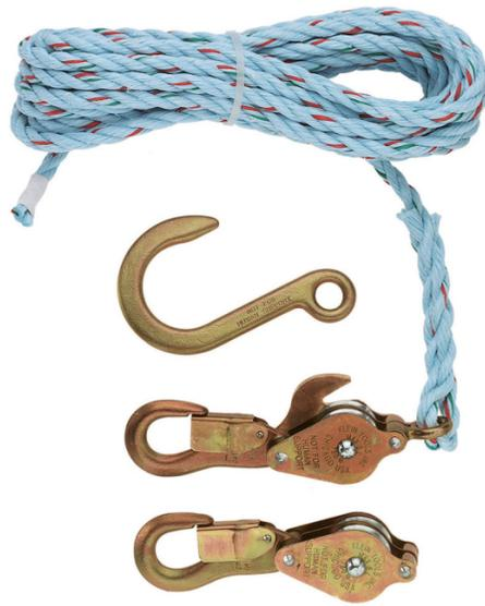
Todos los aparejos de poleas de Klein utilizan cuerda de 3/8" (10 mm) de diámetro de alta calidad. Las poleas de acero galvanizado livianas están equipadas con ganchos de retención para sostener la carga. Este paquete trae dos poleas con un gancho de anclaje estándar cuya carga máxima segura es de 750 lb (340 kg).
