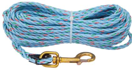
La cuerda de mano con mosquetón de polipropileno de Klein Tools está fabricada con cuerda de polipropileno de tres cordones de 5/16" (8 mm) y 75' (22,9 m) de longitud empalmada al ojal del gancho giratorio. Gancho de acero forjado y horquilla giratoria con bloqueo tipo émbolo de acción rápida.
