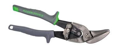
Corte y recorte hojas de metal con la comodidad de las tijeras con cuchillas desplazadas de corte derecho Klein Tools. Las cuchillas están fabricadas en acero forjado con tratamiento térmico para brindar resistencia y durabilidad. Las cuchillas desplazadas permiten realizar cortes en curvas estrechas manteniendo las manos lejos del metal. Los mangos de plástico moldeados con protectores de pulgar están codificados por color según el patrón de corte
