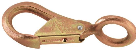
El mosquetón de Klein Tools se conecta fácilmente a cuerdas para trabajos de elevación. Fabricado con acero forjado y cuenta con un bloqueo tipo émbolo de acción rápida. Carga máxima segura: 1500 lb (680 kg).
