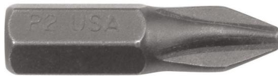
Esta punta de repuesto se adapta a los desarmadores con puntas reemplazables y otros dados que aceptan puntas hexagonales de 1/4". Las puntas pulidas y forjadas con precisión en cromo niquelado tienen una longitud de 1" (25 mm).
