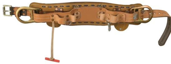
Cinturón completamente flotante de Klein Tools que cuenta con una almohadilla para cinturón de cuero látigo acordonada y cosida con dos bolsillos. Un cinturón acojinado de cuero con bordes doblados para más comodidad al inclinarse hacia atrás. Un cinturón con correa Klein-Kord™ de 1-3/4" (4,4 cm) de ancho con arnés de cuero de alta calidad que garantiza un uso de larga duración.
