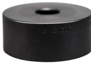
La matriz saca bocados 2.416 de Klein le permite perforar agujeros con facilidad en tubos conduit EMT de 2". Tiene una capacidad máxima de corte de acero blando calibre 10. También corta aluminio, fibra de vidrio y plástico.
