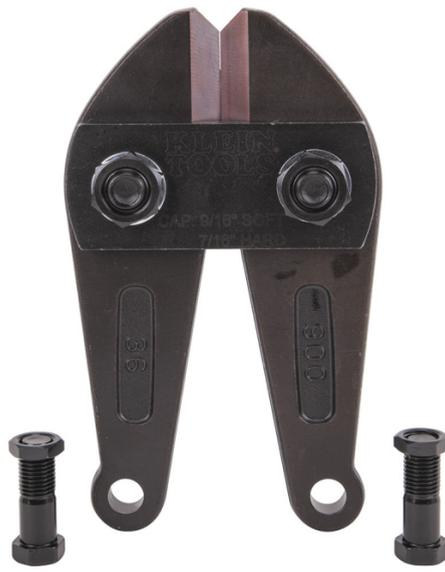
Esta cuchilla de repuesto es apta para el cortador de pernos de 36" (91,4 cm) de mango de acero (Cat. n.º 63336). Corta metales duros, medios y blandos. Acero de aleación forjado rectificado a precisión para lograr un corte seguro y eficaz, y una larga vida útil.
