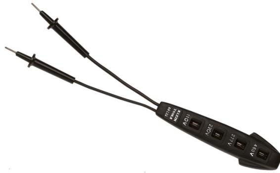
El probador bifilar de voltajes múltiples verifica e indica el voltaje en circuitos CA o CD de hasta 460 V. La unidad prueba polaridad CD, frecuencia y línea polifásica. Cuatro indicadores de neón brillante CA/CD indican el voltaje que se está probando, 110, 220, 277 o 460 V.
