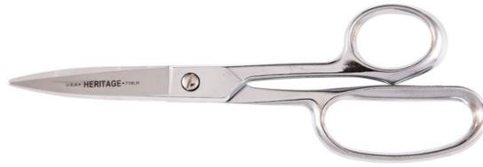
El anillo extragrande permite usar guantes, y el mango largo proporciona mayor palanca de corte. Las cuchillas con filo de precisión producen un corte filoso, limpio y uniforme. Hojas cromadas sobre níquelado resistentes a la corrosión y al óxido. Corta tela, caucho y fieltro. Tijeras de acero forjado en caliente. Hecho en los EE. UU. La longitud de corte es 3" (76,2 mm). La longitud total es 9" (228,6 mm). El peso es 0,48 lb (0,22 kg).
