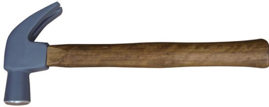
Los martillos normalizados con uña Klein Tools son excelentes para aplicaciones en trabajos generales con madera, especialmente donde hay que reducir al mínimo el riesgo de astillar y dañar los objetos que se golpean. La cabeza está forjada en acero al carbono manganeso duradero y de alta resistencia a la tracción. La cara está normalizada para que sea más suave y tenga menos probabilidades de astillarse.
