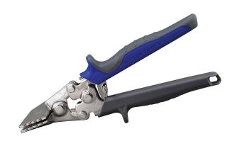
La engastadora manual recta de Klein Tools facilita el trabajo con hojas de metal gracias al mecanismo de palanca compuesta y al práctico cerrojo de apertura automática. Las mordazas de acero de 3" tienen muescas en incrementos de 1/4" para realizar mediciones precisas de los materiales a plegar. Los agarres moldeados y cómodos cubren mangos duraderos fabricados completamente en acero para proporcionar una vida útil prolongada y durabilidad.
