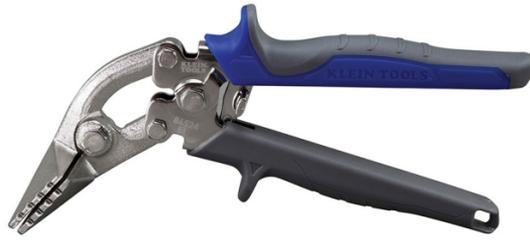
La engastadora manual en ángulo de Klein Tools facilita el trabajo en espacios reducidos gracias al mecanismo de palanca compuesta y al práctico cerrojo de apertura automática. La mordaza de acero de 3" tiene muescas en incrementos de 1/4" para realizar mediciones precisas de las hojas de metal a plegar. Los agarres moldeados y cómodos cubren mangos duraderos fabricados completamente en acero para proporcionar una vida útil prolongada y durabilidad.
