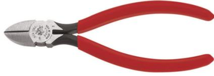
Estas pinzas de corte diagonal con accionado por resorte de Klein Tools están diseñadas para trabajar fácilmente en áreas reducidas gracias a sus mordazas cortas y unión remachada en caliente y accionada por resorte que le proporciona una acción uniforme. Las pinzas están fabricadas con acero estadounidense y con cuchillas templadas por inducción. Los mangos están bañados en plástico para proporcionar mayor comodidad y facilidad de identificación.
