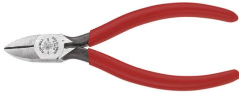
Estas pinzas de 5" de corte diagonal tienen una punta cónica para trabajar fácilmente en áreas reducidas y permitir cortes limpios de puntas. Estas incluyen mordazas cortas y filos de corte estándar biselados para permitir cortes limpios de alambres. Las pinzas están forjadas con acero hecho en EE. UU. y tienen cuchillas templadas por inducción y una unión remachada en caliente para ofrecer una acción uniforme más duradera.
