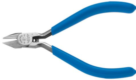
Estas pinzas para uso electrónico de Klein Tools cuentan con una punta fina y afilada, con mordazas extraangostas para trabajos delicados en espacios reducidos. Las mordazas cortas tienen cuchillas de corte completamente al ras biseladas, templadas por inducción para brindar cortes precisos y durabilidad. Los mangos son accionados por resorte para una acción de apertura automática y son bañados en plástico para brindar comodidad y facilitar la identificación.
