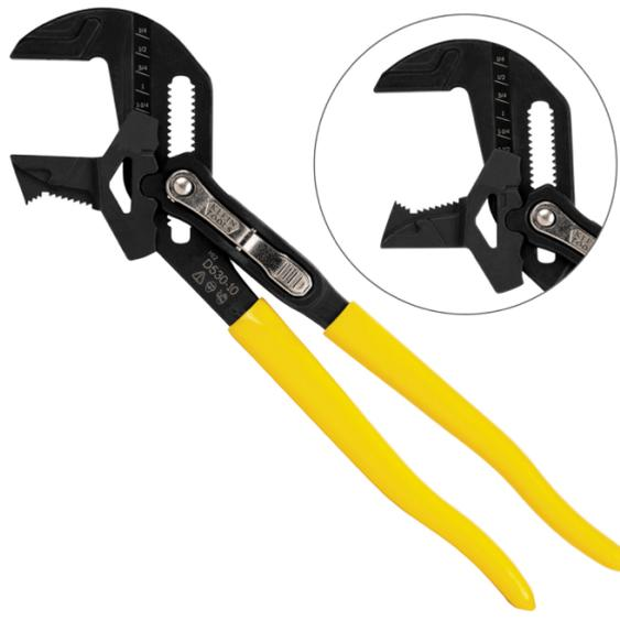
La llave de pinzas de Klein funciona como una llave ajustable en sujetadores de lados planos, y como una pinza para bombas para tuberías y otros objetos redondos. Sus mordazas reversibles ofrecen las características de las mordazas paralelas suaves de las llaves de pinzas tradicionales, con la versatilidad añadida de los dientes moleteados en el reverso cuando se necesita una mordida adicional, así como un ajuste único y eficiente.
