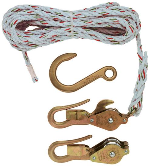
Todos los aparejos de poleas de Klein utilizan cuerda de 3/8" (10 mm) de diámetro de alta calidad. Las poleas de acero galvanizado livianas están equipadas con ganchos de retención para sostener la carga. Este paquete trae dos poleas con un gancho estándar forjado de Klein Cat. n.º 258 cuya carga máxima segura es de 750 lb (340 kg).
