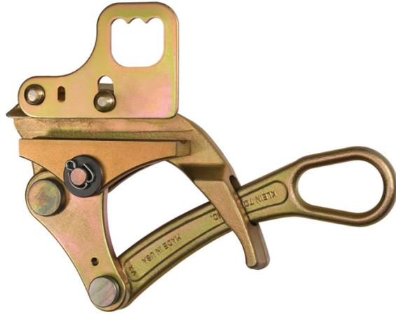
Los agarres tensores forjados de quijada paralela Klein KT4802 con ojal de gran abertura con cerrojo rápido en el mango son ideales para admitir una gran variedad de plumas, tornos y aparejos. El cerrojo rápido se cierra automáticamente para evitar que el agarre se desenganche del cable por accidente. El agarre tensor KT4802 tiene una mordaza de 5-1/8" de largo.
