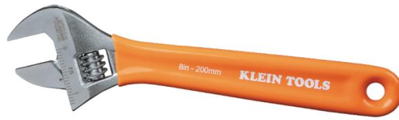
La llave ajustable de capacidad extra de 8" (200 mm) de Klein Tools está fabricada en acero de aleación forjado, con tratamiento térmico, liviano y de máxima resistencia. Las mordazas están maquinadas a precisión para garantizar un funcionamiento sin problemas. Los mangos bañados en plástico y moldeados facilitan el agarre y la comodidad de uso.
