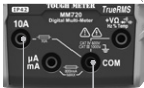
Rote Leitung Schwarze Leitung
