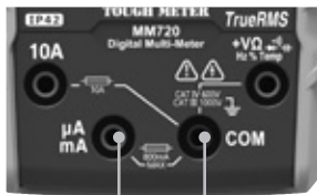
Rote Leitung Schwarze Leitung
